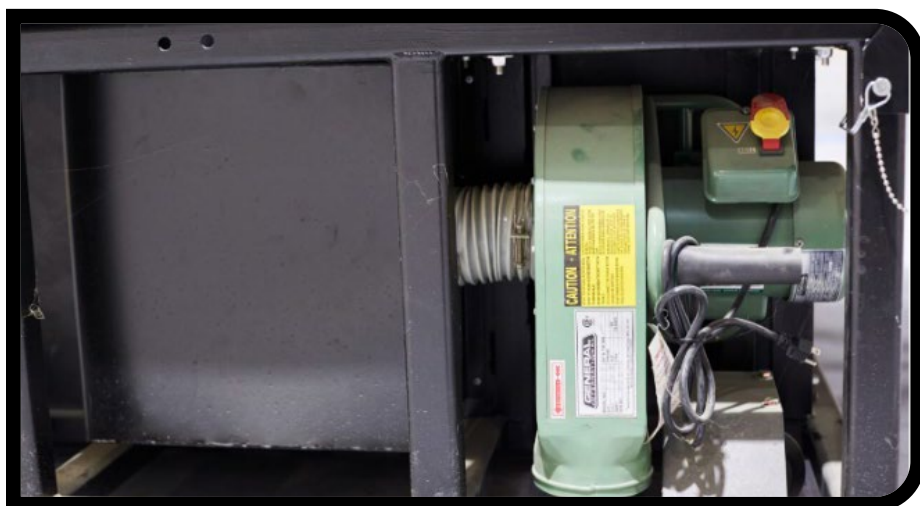
Figure 27 : Système de dépoussiérage du caisson de creusage
