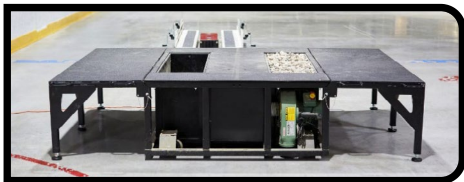
Figure 26 : Caisson de creusage déployé
